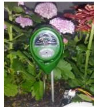
Gambar 13. Pengujian Sensor Soil Moisture Dengan Alat Ukur Standar
