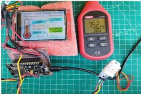
Gambar 11. Pengujian Sensor DHT22 dengan Alat Ukur Suhu UT333
