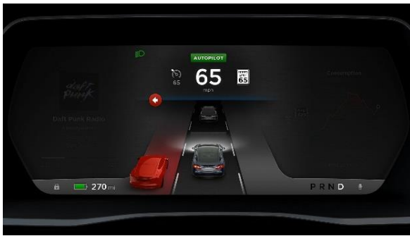
Gambar 7. Ikon Auto Pilot pada Panel Instrumen Tesla. (Sumber : OF.Vynakov, EV Savolova., A.I Skrynnyk)
