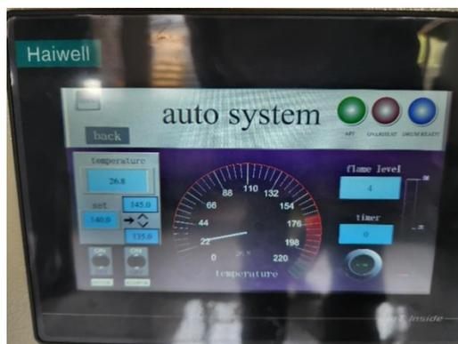
Gambar 9. Tampilan menu *auto system* untuk mengatur set point suhu.
