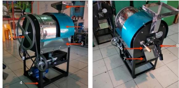
Gambar 3. Bagian mekanik mesin sangrai kacang.
