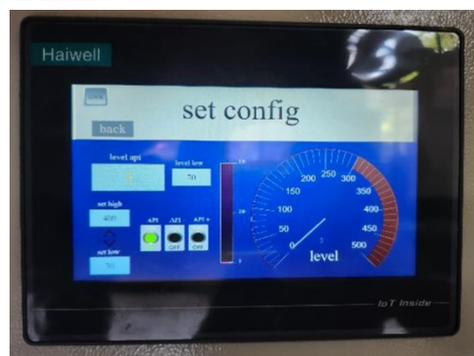
Gambar 8. Tampilan menu *set config* untuk mengatur level api.
