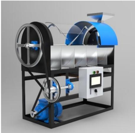
Gambar 2. Desain 3D mesin sangrai otomatis.
