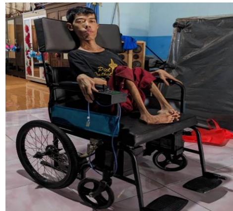
Gambar 2.4 Kursi roda elektrik hasil konversi dari kursi roda manual milik Peserta kedua
