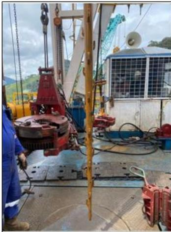
Gambar 3 Hasil fishing job ketiga : Terdapat slickline pada peralatan cable spear namun fish terlepas pada saat POOH rangkaian.
