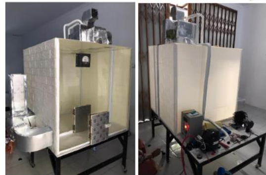
Gambar 2. Unit Pendingin Ruang Tekanan Negative Yang Telah Dibuat Tampak Depan Dan Belakang.
