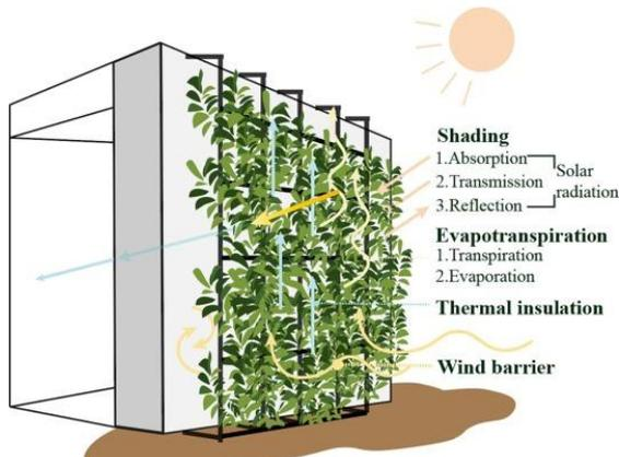
Gambar 18. Ilustrasi distribusi termal dengan facade hijau
