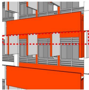
Gambar 17. Pengurangan shading untuk memperlebar bukaan (Sumber: Analisis Peneliti)
