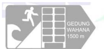
Gambar 9. Contoh Rambu Evakuasi Lengkap dengan Simbol, Nama Gedung dan Jarak menuju ke Tempat Kumpul berupa Bangunan Sumber : SNI 7743:2011
