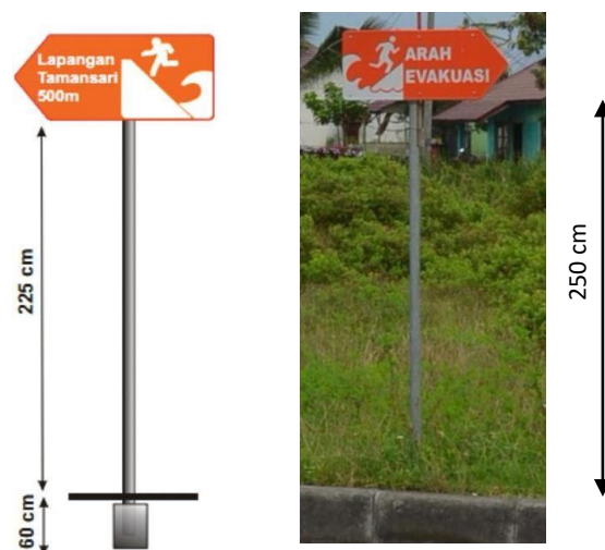
Gambar 16. Perbandingan Pengukuran Dimensi Rambu Evakuasi Tsunami Berdasarkan (SNI) 7743:2011
