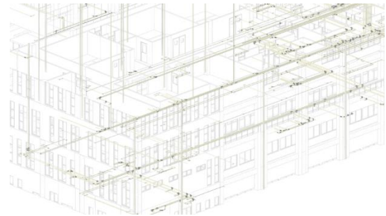
Gambar 9 Pemodelan pemipaan air bersih dan air kotor
