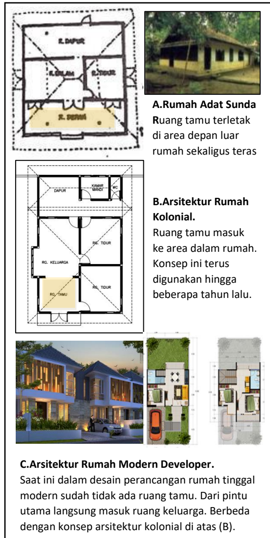
Gambar 1. Transformasi Ruang Tamu (Sumber : Analisa Pribadi)
